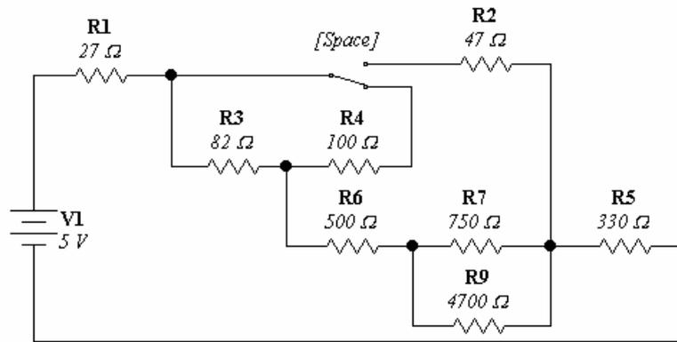
Soluciones llave hacia abajo:  $I_{R_1} = 3.22_{[mA]}$ ;  $I_{R_2} = 0_{[A]}$ ;  $I_{R_3} = 1.76_{[mA]}$ ;  $I_{R_4} = 1.45_{[mA]}$ ;  $I_{R_5} = 3.22_{[mA]}$
