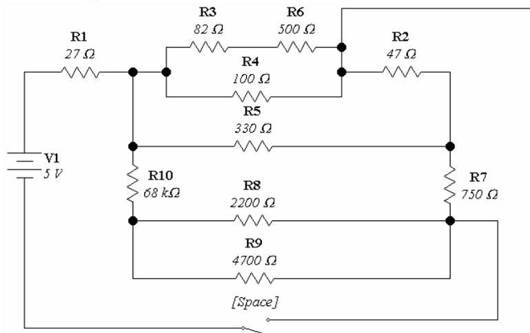
Soluciones llave hacia abajo:  $I_{R_1} = 51.79_{[mA]}$ ;  $I_{R_2} = 9.58_{[mA]}$ ;  $I_{R_3} = 6.18_{[mA]}$ ;  $I_{R_4} = 36_{[mA]}$ ;  $I_{R_5} = 9.53_{[mA]}$ ;
