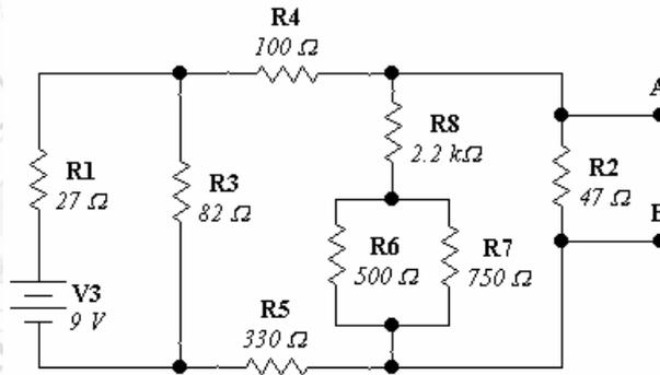
Solución:  $V_{AB} = 628.39_{[mV]}$
