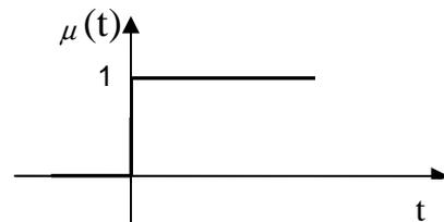
La función es cero para todo valor de tiempo negativo, y uno para todo tiempo positivo. La operación de cambio (cierre en el ejemplo de tensión, apertura en el de corriente) ocurre en el corto intervalo entre  $0^-$ , donde la función es cero, y  $0^+$ , cuando la función es igual a uno. En el instante  $t = 0$  está indeterminada.
