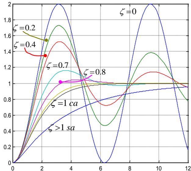
En la figura anterior se ve la incidencia del parámetro  $\zeta$  en la forma de la respuesta, según sea  $\zeta$  el sistema será subamortiguado, amortiguado crítico ó sobre-amortiguado.
