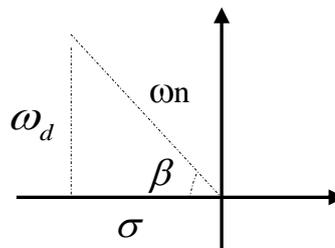
**tp:** Es el tiempo requerido para que la respuesta alcance el primer pico de sobre-impulso. El tiempo pico se obtiene derivando la ecuación de respuesta  $c(t)$  e igualándola a cero, con lo que se obtiene:
