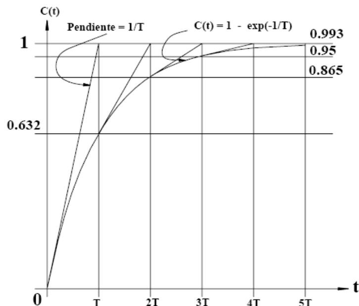
“T” es la constante de tiempo del sistema y para un valor de 5 veces T, la respuesta es prácticamente igual a la entrada; por lo que si  $t \rightarrow \infty$  el error (diferencia entre las señales de entrada y salida) tiende a cero.
