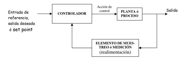
Como se puede ver en el esquema, un S.C.L.C., presenta una señal de realimentación, la cual es comparada con la señal de entrada para producir la señal de error. El controlador debe intentar reducir este error, produciendo la acción de control necesaria. Este mecanismo de realimentación y comparación, puede efectuarse en forma manual o automática, siendo este último el de nuestro interés.
